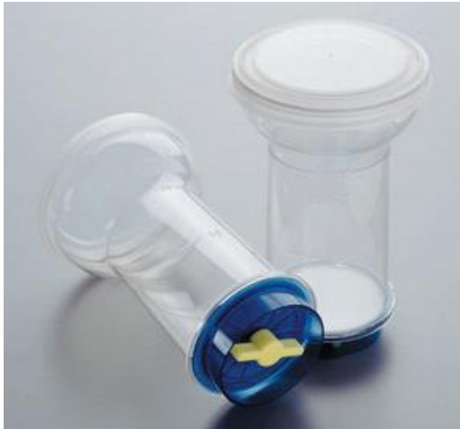
Figure 14 : Dispositif de filtration sterisure membrane en esters de cellulose 0,45 \mu\text{m}
