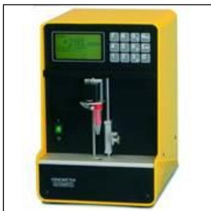
Figure 13 : Osmomètre cryoscopique
