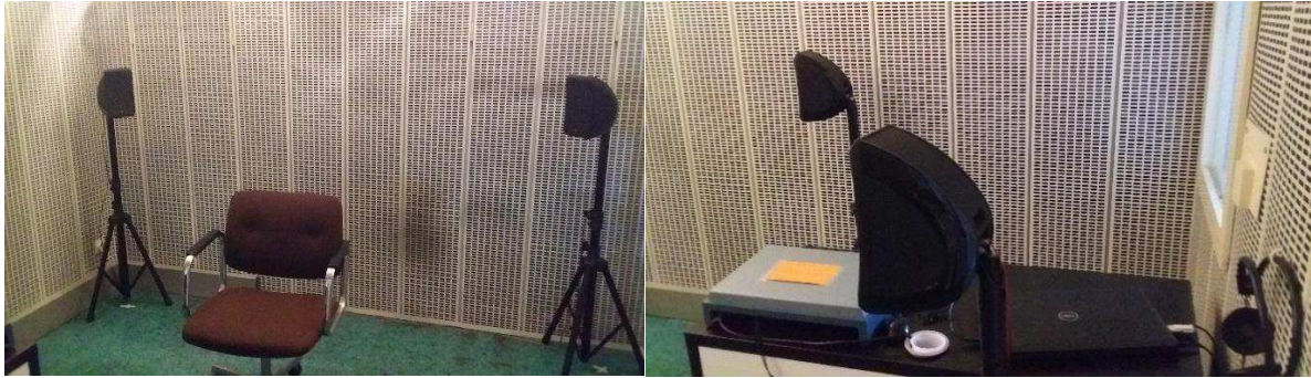
Figure 9 : Photos de la cabine de test Le participant s'installe sur la chaise au centre de la cabine. Le bureau pour l'examineur avec l'audiomètre, l'ordinateur générant le test d'audiométrie vocale dans le bruit et le casque d'audiométrie tonale sont disposés latéralement.
