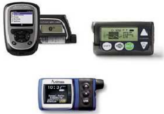
Figure 7. Exemples de pompes à insuline externe (14)
