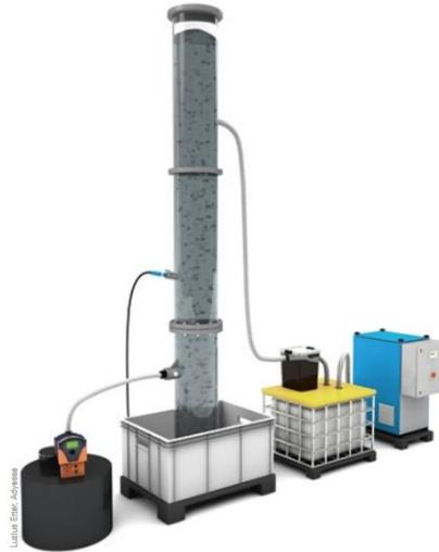
Figure 3 : Illustration d'une installation pilote avec une colonne de nitrification et un distillateur (Etter *et al.*, 2015).
