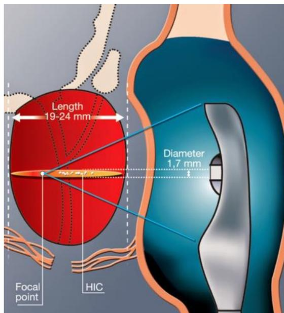
Figure 1 : Lésion induite par ultrason focalisé de haute intensité
