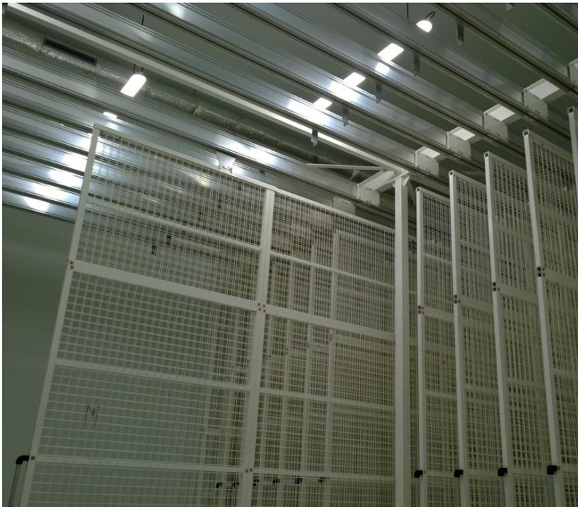
La partie haute de chaque grille est suspendue dans un rail, tandis que la partie basse repose sur des roues avec un système de butée au sol pour la sécurité.
