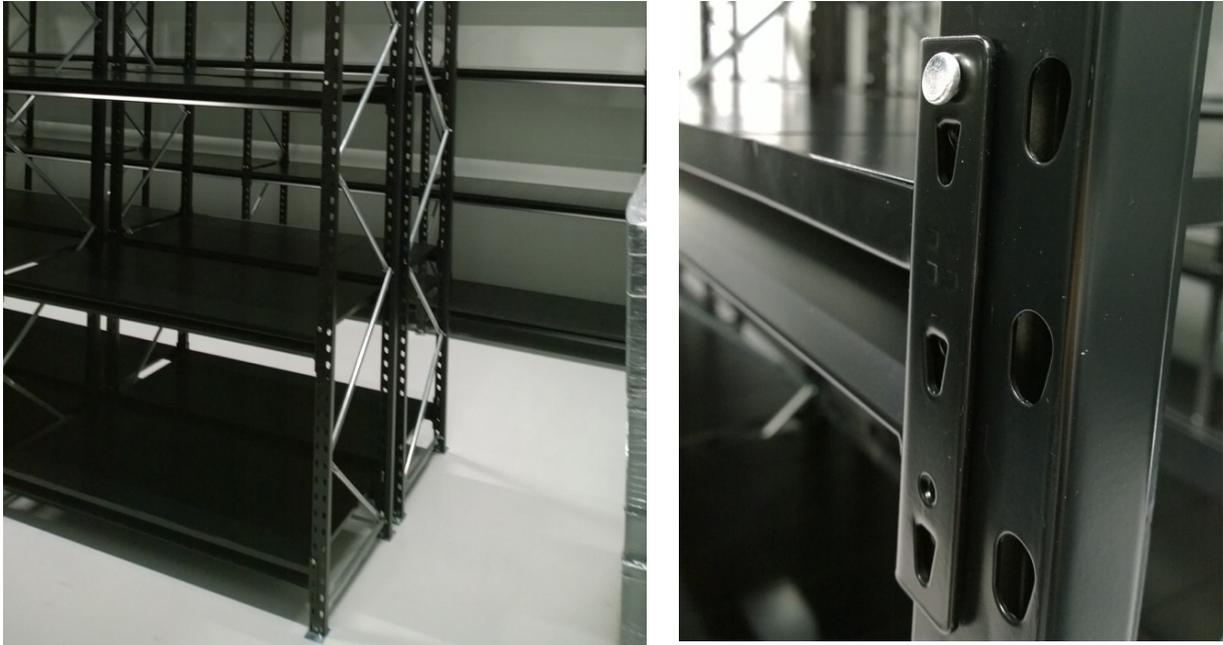
Ils sont renforcés par des contreventements (tubes en acier gris visibles sur la photographie ci-dessus à gauche) et ont l'avantage d'avoir des niveaux réglables manuellement et sans besoin d'outils, grâce à un système de goupilles qui maintiennent les longerons (photographie ci-dessus à droite) sur lesquels sont posés plusieurs planches en acier facilement amovibles.
