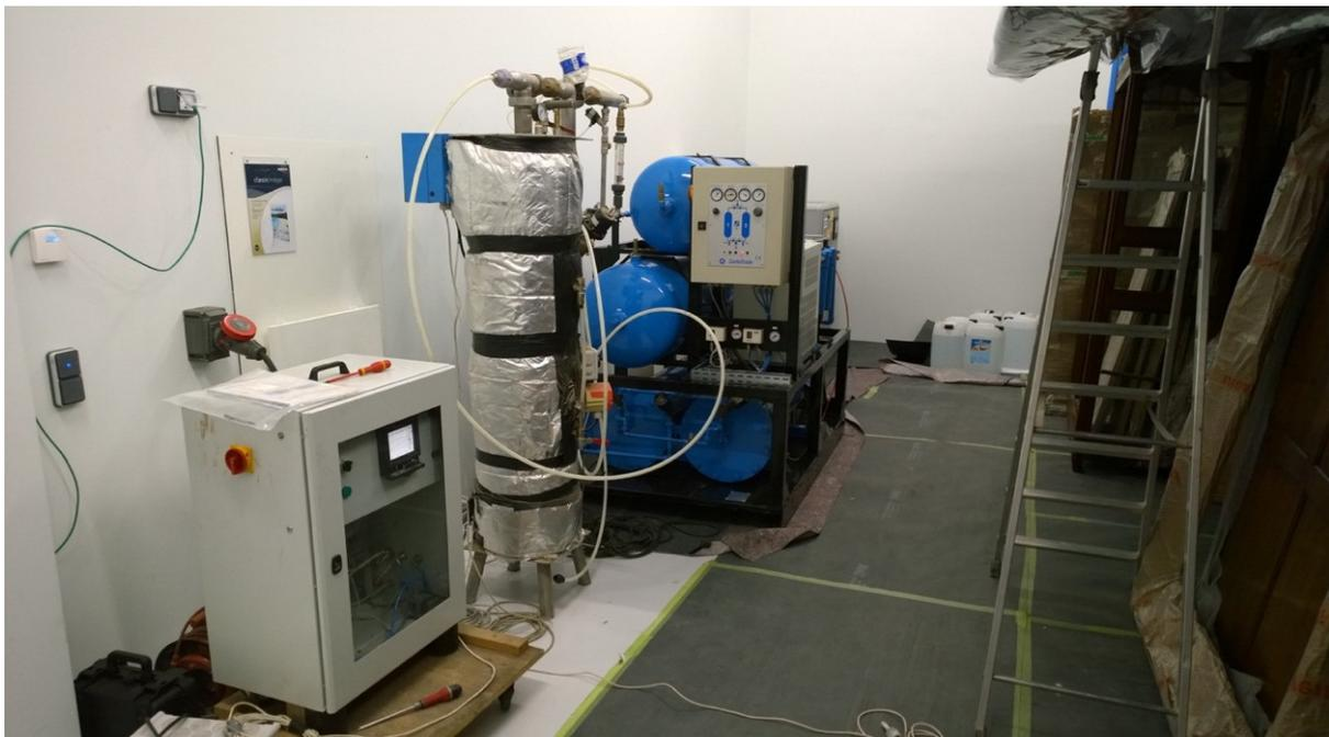
le bloc blanc (à gauche) est l'analyseur de l'air à l'intérieur de la bulle, via un graphique avec une courbe verte pour Oxygène, une courbe rouge pour humidité relative et une courbe mauve pour la température ; juste après se trouve l'humidificateur (cylindre) qui contient 60 L d'eau qui sera envoyée à l'état gazeux dans la bulle (les œuvres ont besoin d'un minimum d'humidité) ; au fond se trouve le bloc avec les bidons bleus qui est le générateur d'azote.
