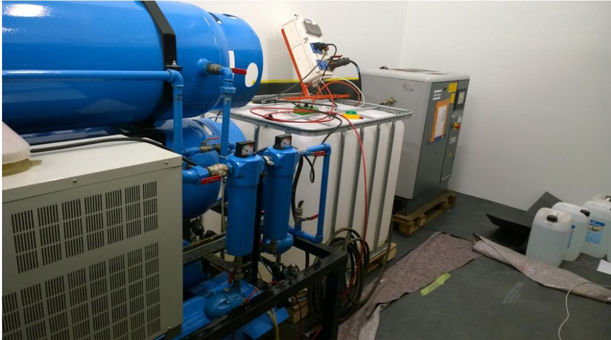
Il est à noter que pour que l'anoxie soit efficace, il faut baisser l'humidité de l'air de la bulle. Le dernier bloc à droite est le compresseur dont le rôle est de prendre l'air ambiant et de l'envoyer dans le générateur qui sépare l'oxygène et l'azote.
