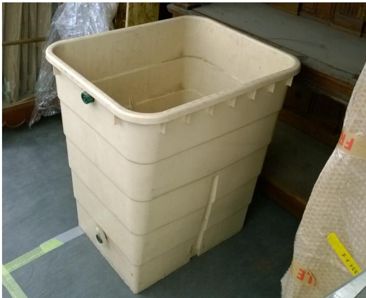
Enfin, le tuyau qui envoie l'azote doit être branché à une cuve à l'intérieur de la bulle (photographie ci-contre avant le branchement) qui sert à atténuer l'entrée de l'air et à éviter d'éventuelles projections de liquide sur les œuvres.
