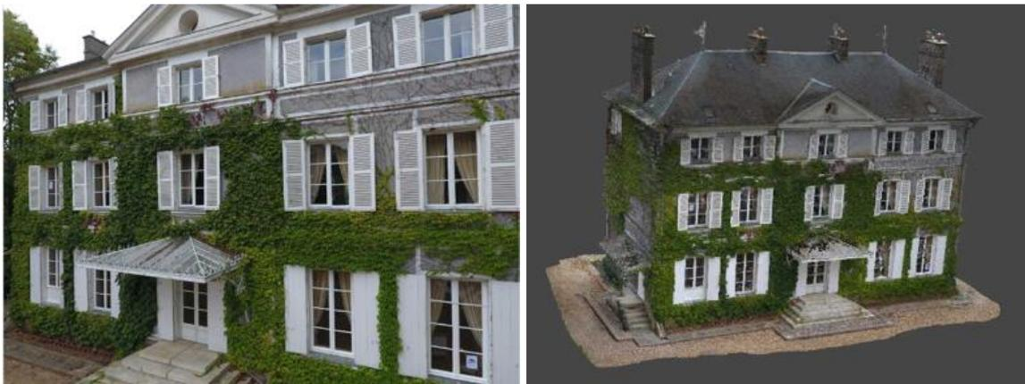
Figure 6 : Image de la façade prise par drone et maillage 3D du bâtiment sur Metashape
