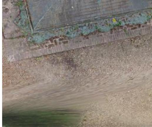
Figure 26 : Zone de déformation dans l'orthophoto générée à partir du MNS de Metashape.
