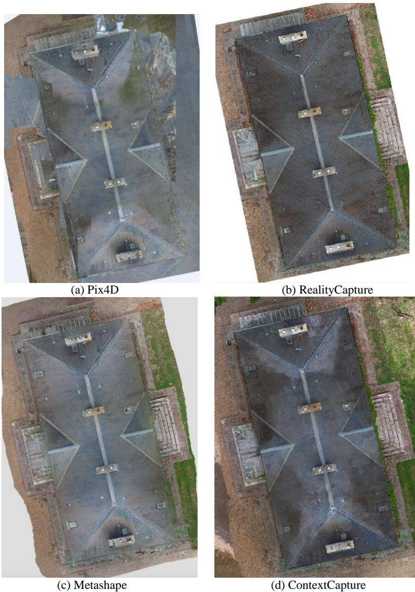
Figure 25 : Orthophotos des différents logiciels
