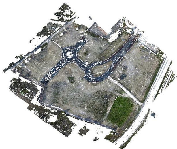
Figure 25 : Nuage de points de liaison dérivant du processus d'ajustement des faisceaux utilisé pour l'orientation relative du bloc d'images.
