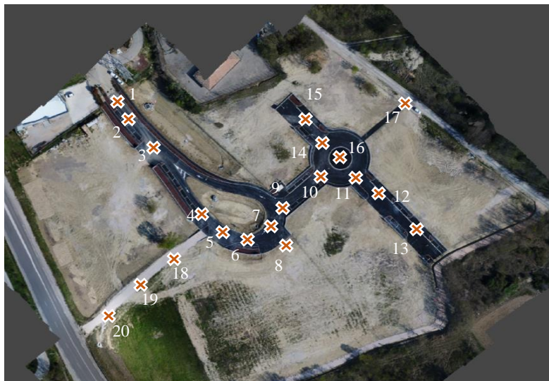
Figure 29 : Illustration des points de contrôle issus du récolement de travaux fait par topométrie classique. Les points sont répartis sur des regards le long de la voirie.
