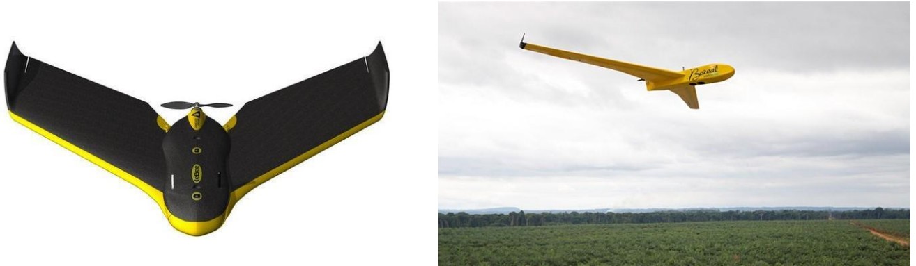
Figure 6 : Photographie de deux drones de même type mais de dimensions différentes (A gauche, le drone Sensefly ebee mesurant 0.76 m d'envergure [www.sensfly.com], à droite le drone « LeBoreal » mesurant 4.20 m d'envergure [www.boreal-uas.com])
