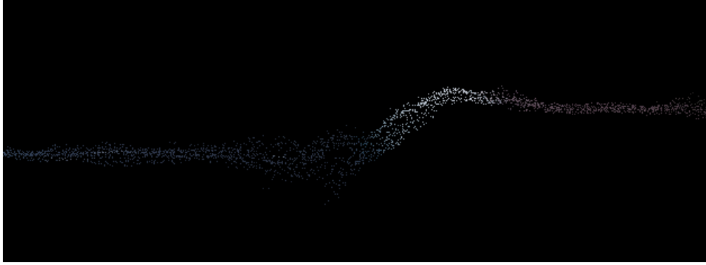
Figure 32 : Extrait de la coupe d'une portion de voirie nous permettant de voir la mauvaise modélisation de la bordure
