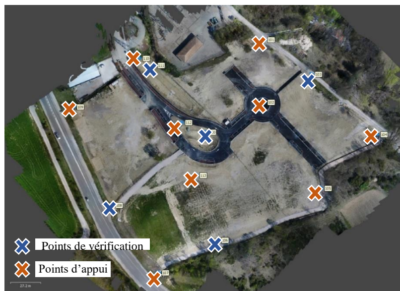
Figure 28 : Illustration de la disposition des points de calage et de vérification
