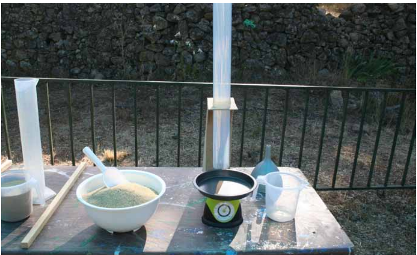
Les phénomènes de blocage dus aux chaînes de force
