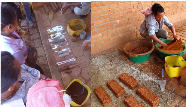
Caractérisation des terres et fabrication des briques terre-paille
