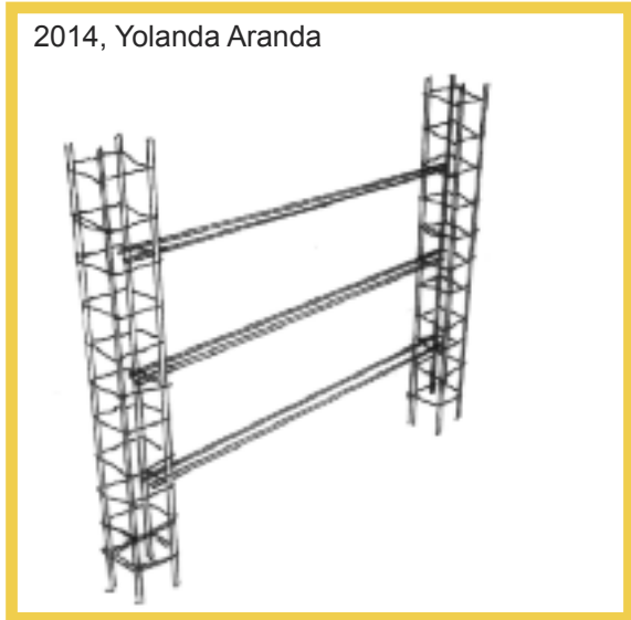
2014, Yolanda Aranda Fig. 70 Technique: terre coulée. Armature des lames de bambou. (Aranda 2014)
