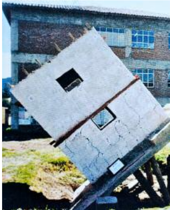
Fig. 128 Prototype MSM2 à 40^{\circ}15' pendant le test semi-statique. (Kok, Sovero, 1996)
