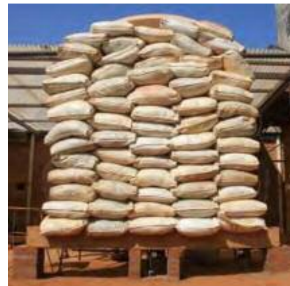
Fig. 141 Poutre en terre coulée (19cm de hauteur) renforcé avec acier, chargé 3250kg avec une déflexion de 9.03mm (photo : Browne)(Browne, 2013. p.35)
