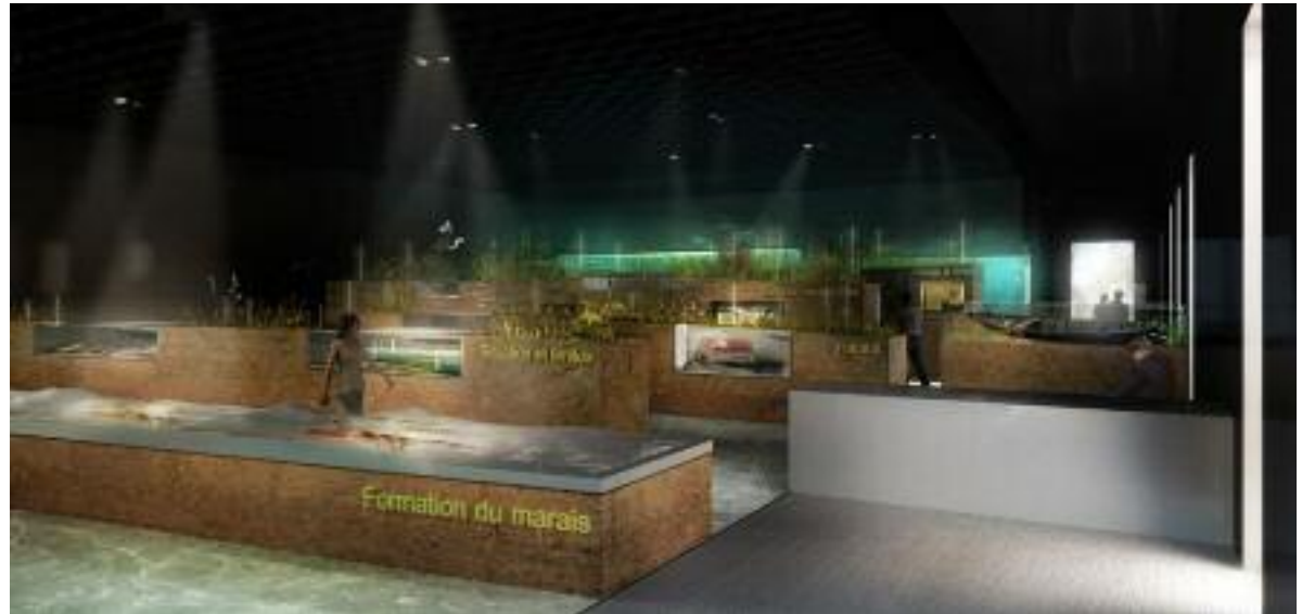
Fig. 274 Perspective du hall principal de musée. Les modules sont des murs de terre coulée qui supportent des maquettes, écrans, panneaux, aquariums et terrariums de l'exposition. (B.A.E. 2013)
