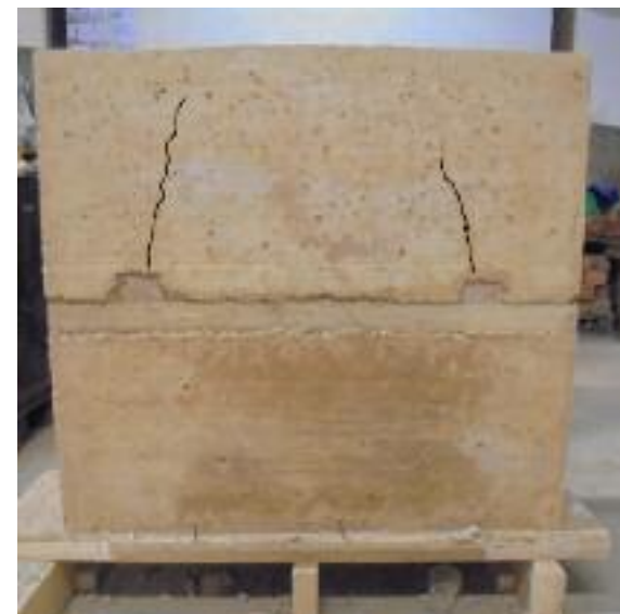
Fig. 227 Fissures du rétrécissement du muret C du à l'inclusion bois.
