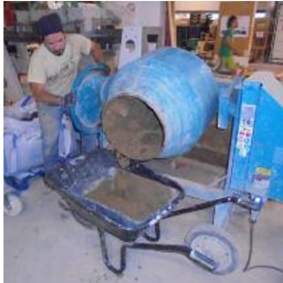
Fig. 26 Préparation de terre coulée pour échantillons soumis à charges cycliques. Voir pages 91-98.
