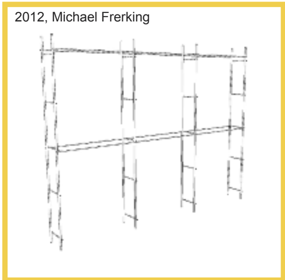
2012, Michael Frerking Fig. 72 Technique: terre coulée. armature des tiges d'acier qui forment des échelles dans le sens transversal des murs et qui sont reliées entre elles par d'autres tiges horizontales.
