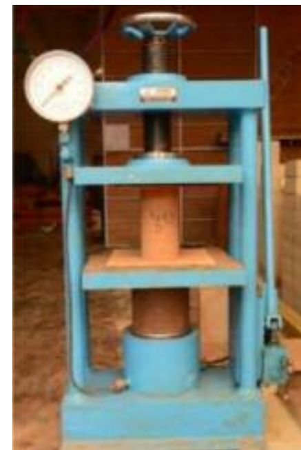
Fig. 50 Presse de l'Auroville Earth Institute pour les essais de compression. (Browne, 2014)
