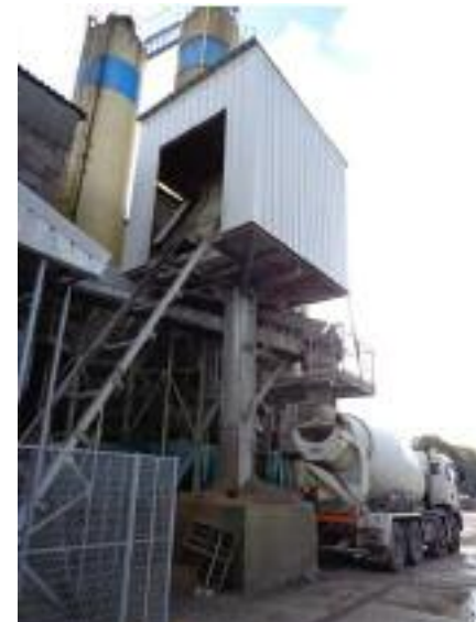
Fig. 36 Prémix de terre coulée dans le central des carrières de Boulonnais, pour le chantier de la Maison du Marais. (Moevus, B.A.E., 2013)
