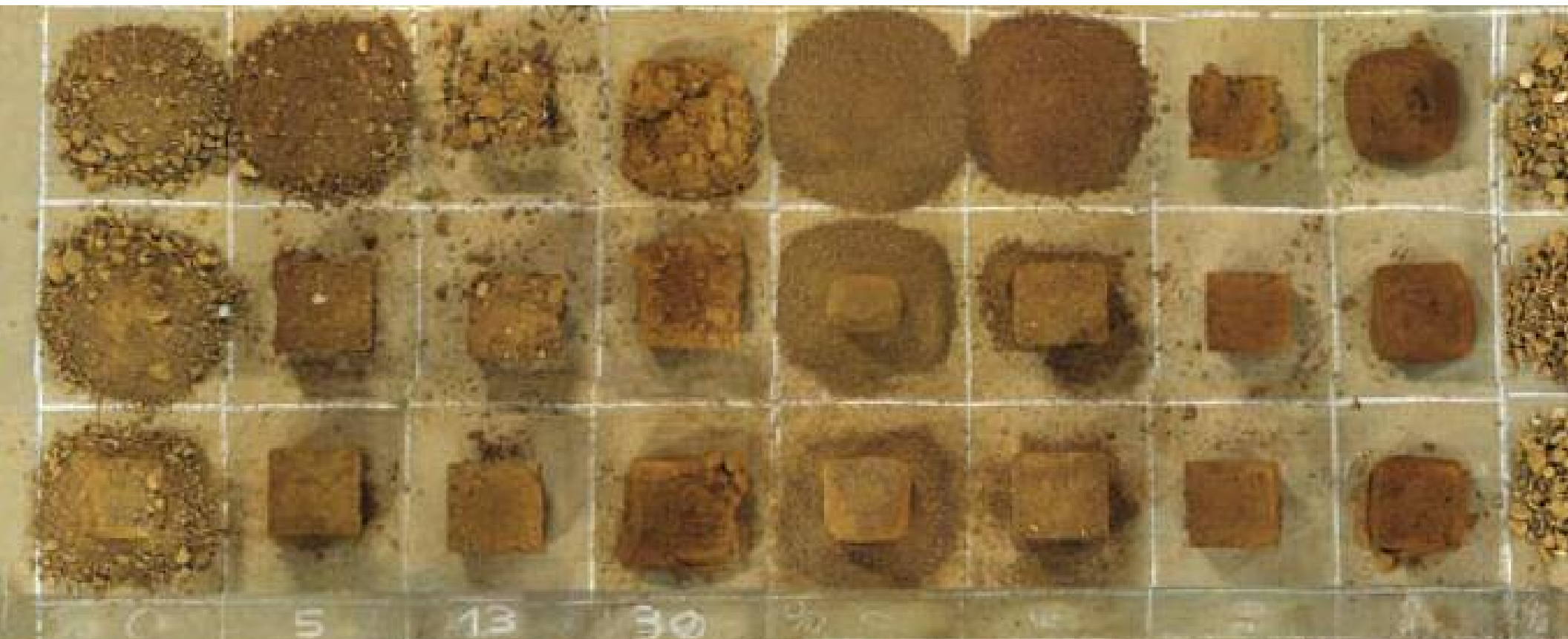
Fig. 6 Échantillons du « Test Carazas ». La première ligne correspond à la terre simplement versée dans les moules. La deuxième au tassement avec la main, et la troisième au tassement avec une petite dame. (Le Tiec, Paccoud, 2006)
