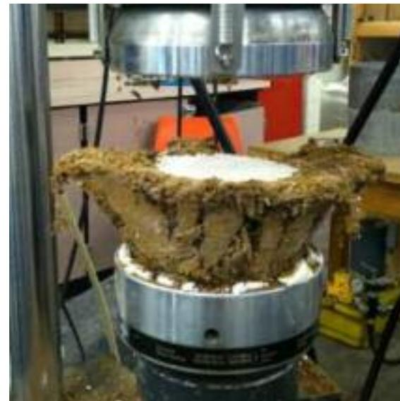
Fig. 8 Échantillon après rupture. Les fibres maintiennent ensemble toute la masse de l'échantillon (Simenson, 2011).
