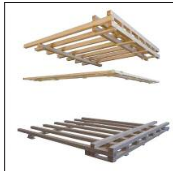
Fig. 108 Culture constructive « Tag ». Il n'y a pas de renforcement vertical. (Langenbach, 2012)
