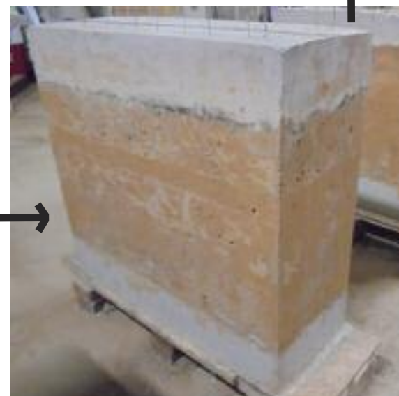
Fig. 157 Photo de muret en terre coulée avec poutres en béton.
