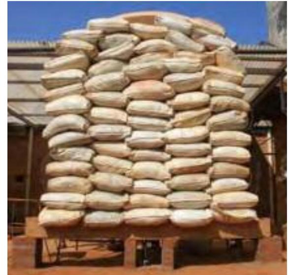
Fig. 141 Poutre en terre coulée (19cm de hauteur) renforcé avec acier, chargé 3250kg avec une déflexion de 9.03mm (photo : Browne)(Browne, 2013. p.35)
