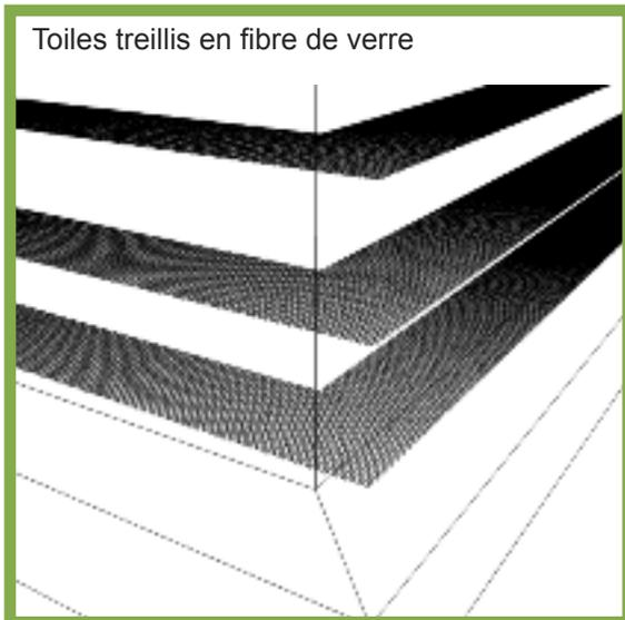
Fig. 174 Des toiles treillis en fibre de verre ou en fibre de jute ou une autre fibre naturelle pourraient s'utiliser comme renforcement horizontaux.
