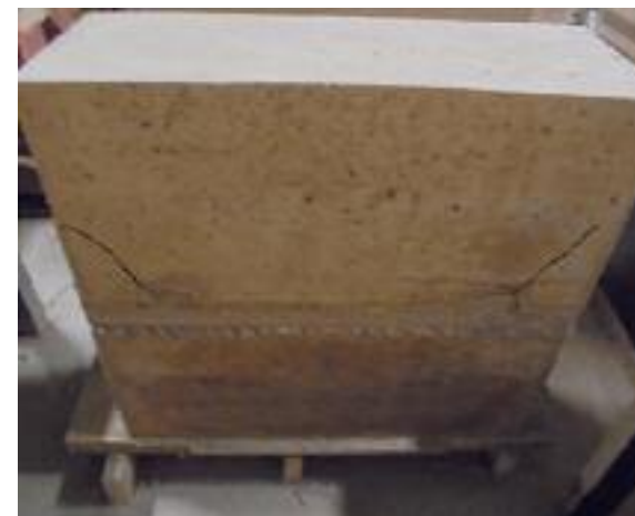
Fig. 227 Fissures du rétrécissement du muret C du à l'inclusion bois.
