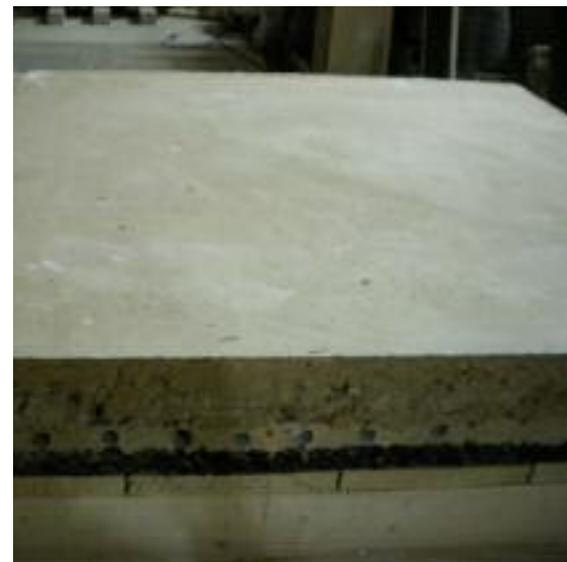
Fig. 254 Vue en coupe d'un essai de la dalle à construire, faite en atelier avant la mise en œuvre en chantier. (Joris, 2011)
