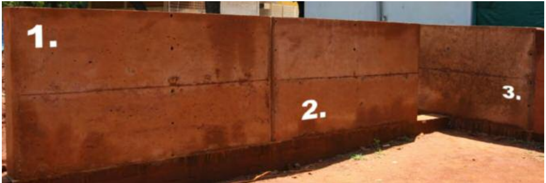
Fig. 46 Murs en terre coulée de 24x120x225 centimètres. Les formules de trois murs en pourcentage de composant, terre : sable : gravier concassé : gravier 1/2", gravier 1", sont les suivantes. Mur 1, 25%:25%:15%:15%:20%. Mur 2, 20%:20%:20%:20%:20%. Mur 3, 15%:25%:15%:25%:20% (Cochet, 2011).
