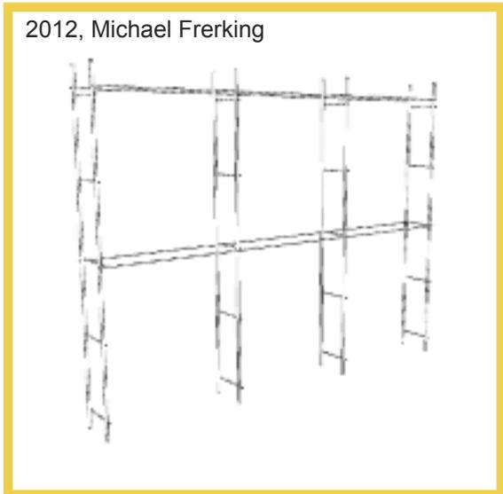
Fig. 72 Technique: terre coulée. armature des tiges d'acier qui forment des échelles dans le sens transversal des murs et qui sont reliées entre elles par d'autres tiges horizontales.
