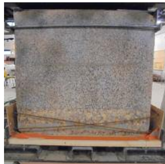
Fig. 239 Troisième manière de fixer le muret à la machine avec des tiges en acier pour prendre les efforts de traction.
