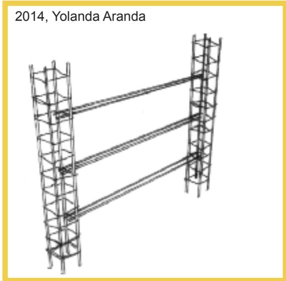
Fig. 70 Technique: terre coulée. Armature des lames de bambou. (Aranda 2014)
