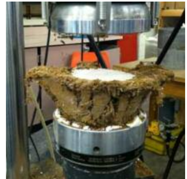
Fig. 8 Échantillon après rupture. Les fibres maintiennent ensemble toute la masse de l'échantillon (Simenson, 2011).
