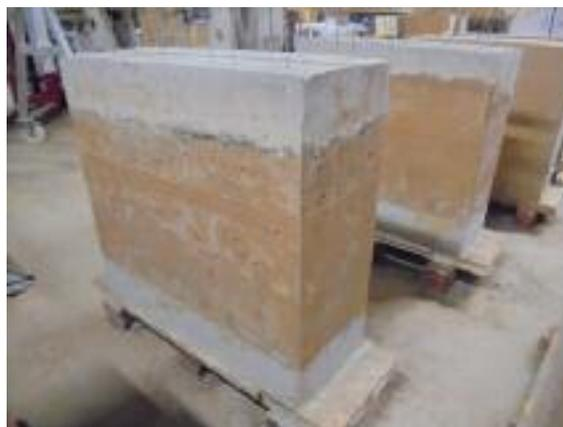
Fig. 232 Murets G et H avec une section de terre coulée entre deux section de béton.
