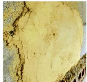
La terre accrochait très bien aux parpaings, même avec une épaisseur de 4 cm (Test 1 : 75% de paille). Tous les échantillons présentaient de petites fissures après séchage sauf les échantillons 1 et 2. Néanmoins, le comportement de l'échantillons 6, avec moitié de terre du terrain, avait le même comportement que la terre importée d'un autre terrain.
