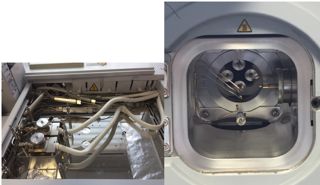
Figure VII: à gauche : système d'injection , à droite : chambre d'ionisation
