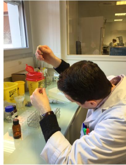
Nous ajoutons ensuite un bouchon de NaCl en poudre pour saturation du liquide puis nous agitons 15 secondes. Viennent ensuite les étapes d'extractions :
