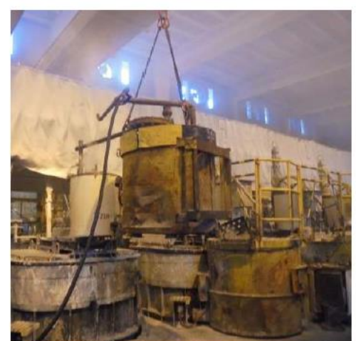
Vidange du sodium dans la cheminée
