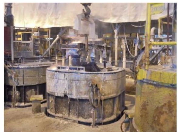
Nettoyage du collecteur et remise du bain dans la cellule
