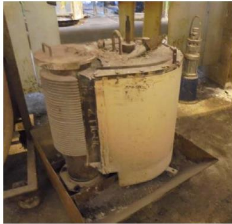
Récepteur avec son couvercle soupape de sécurité
