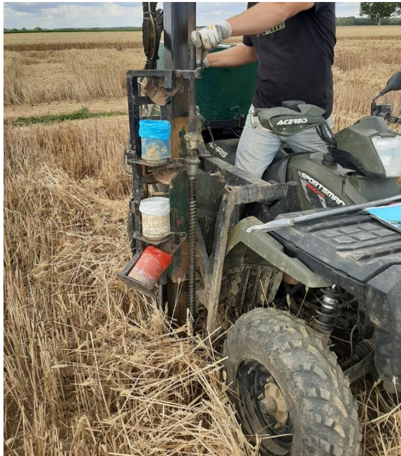
Tarière hydraulique utilisée pour le reliquat post-récolte
