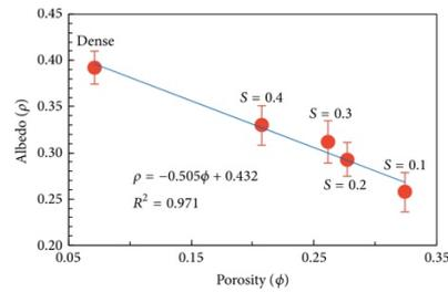
Figure 16 : Albédo de bétons drainants de différentes porosités ( Source : ZHANG et al., 2015)
