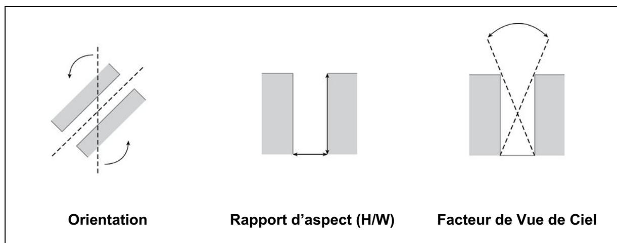
Figure 11 : La géométrie d'un canyon urbain peut être décrite par son orientation, ratio H/W et FVC (Source :Mantazeri dans Boeters et al., 2012)
