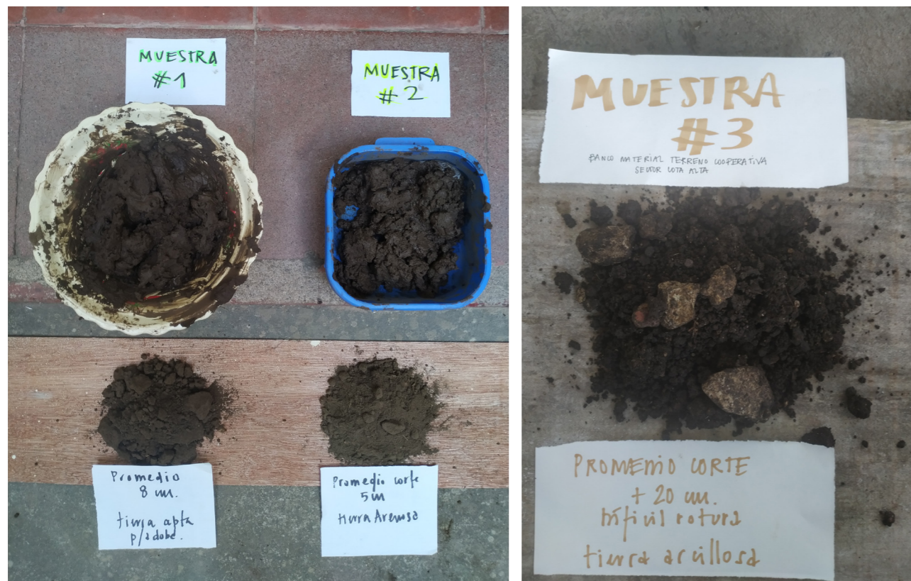
07. Pour l'élaboration des adobes, différents sols ont été prélevés sur le site et les tests de terrain ont été effectués afin d'élaborer un adobe qui réponde aux exigences techniques pour assurer sa durabilité. Le processus a été réalisé par l'ingénieur Kenia Lopez et l'architecte Maira Valdiviezo
