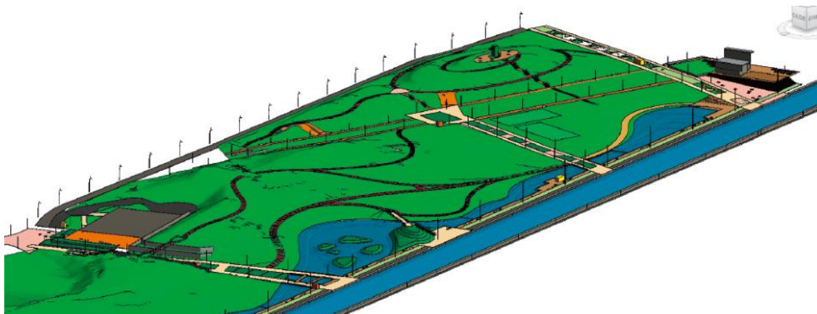
Fig.17 : Capture d'écran Revit® du socle topographique LIM® du parc de la Bergère à Bobigny, Source : (Land'Act, 2019)
