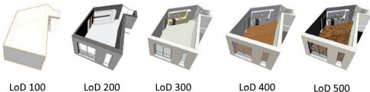
Fig.6 : Niveaux de détail ou Lod (Level of detail), Source : (datBIM, dossier du 05/10/2018)
