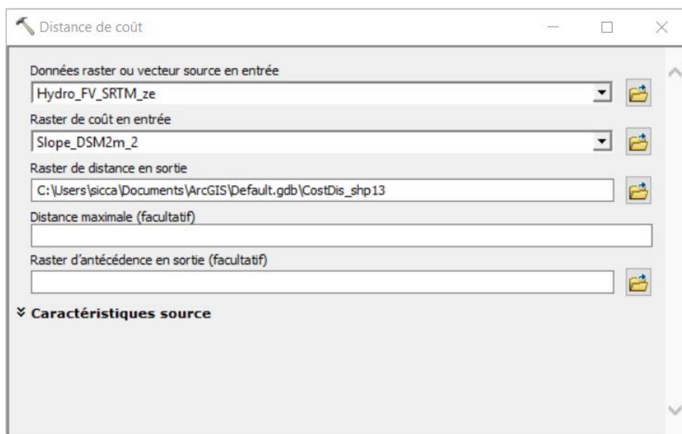
Figure II-27 : Délimitation du fond de vallée à partir du traitement "Distance-coût" (Réalisation : Vincent Siccard, UCN, 2020)
