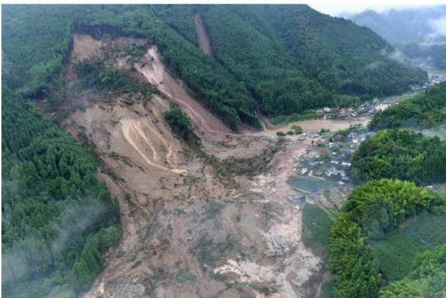
Figure 0-1 : Glissement de terrain déclenché par les pluies torrentielles de juillet 2017 dans la Préfecture d'Oita (Kyushu, Japon)
