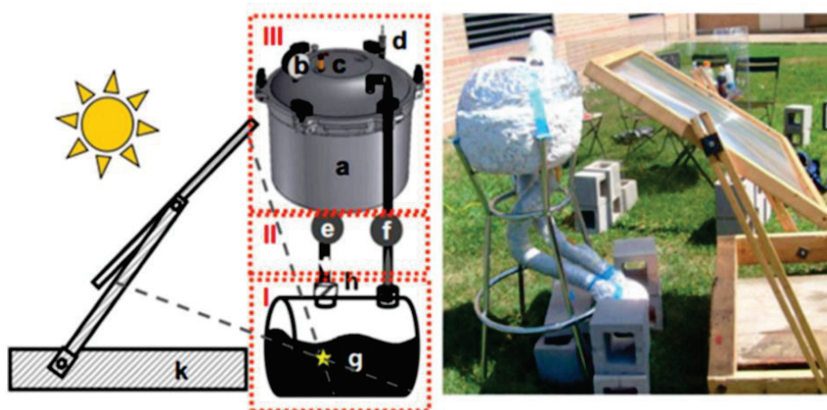
Figure 22 : Schéma et photographie d'un autoclave solaire étudié (292)
