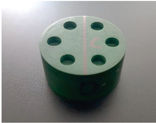
Figure 22 : Moule de confection des plots pour la microdureté
