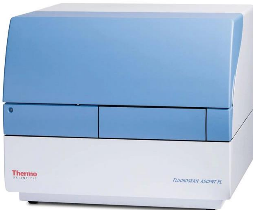
Figure 8. Le Fluoroskan Ascent® : automate du test de génération de thrombine
