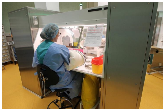
Figure 8 : Isolateur bi-poste SIEVE®
