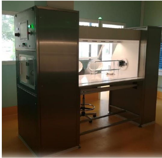
Figure 9 : Isolateur monoposte SIEVE®
