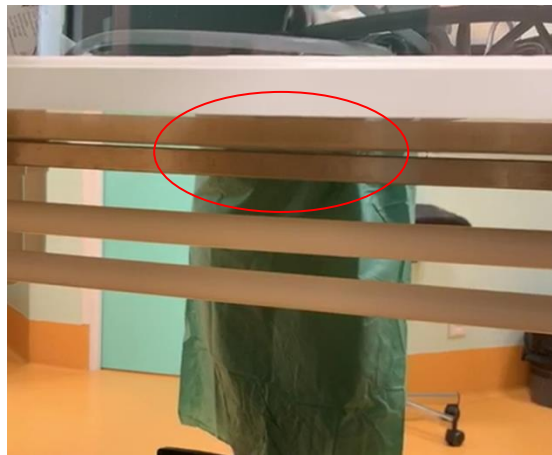
Figure 24 : Déformation du plan de travail de l'isolateur
