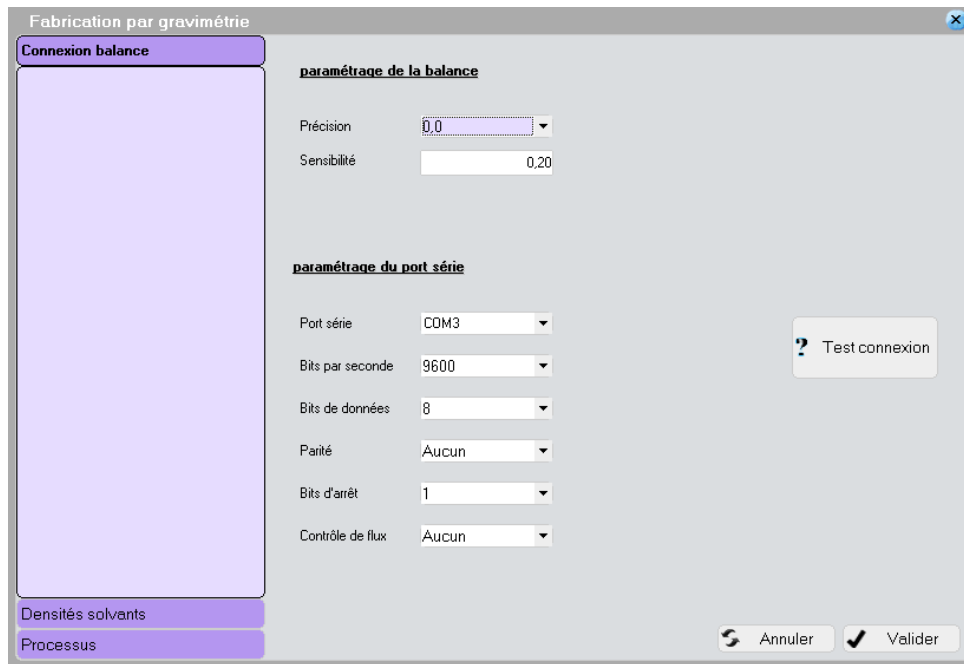
Figure 28 : Test de connexion de la balance à CHIMIO® [47]
