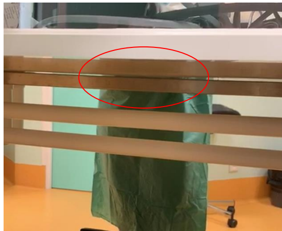
Figure 24 : Déformation du plan de travail de l'isolateur
