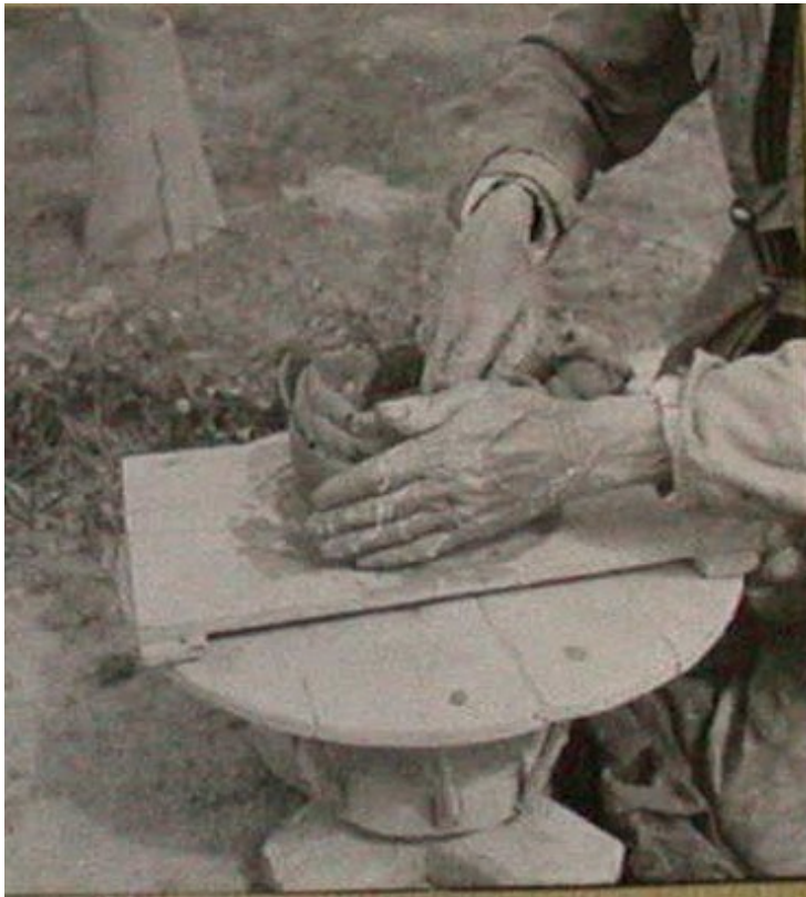
Fig. 28 : Montage au colombin. Source : MNATP. Photo 48 34 28
