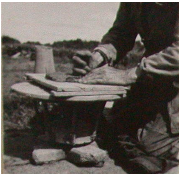
Fig. 27 : François Cuëff en train de confectionner le fond du pot. Source : MNATP. Photo 48 34 18
