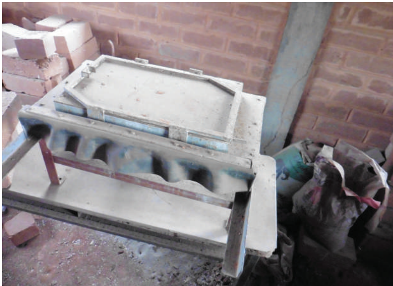
◀ La table vibrante pour tester les BTC, fabriquée avec un moteur de machine à coudre
