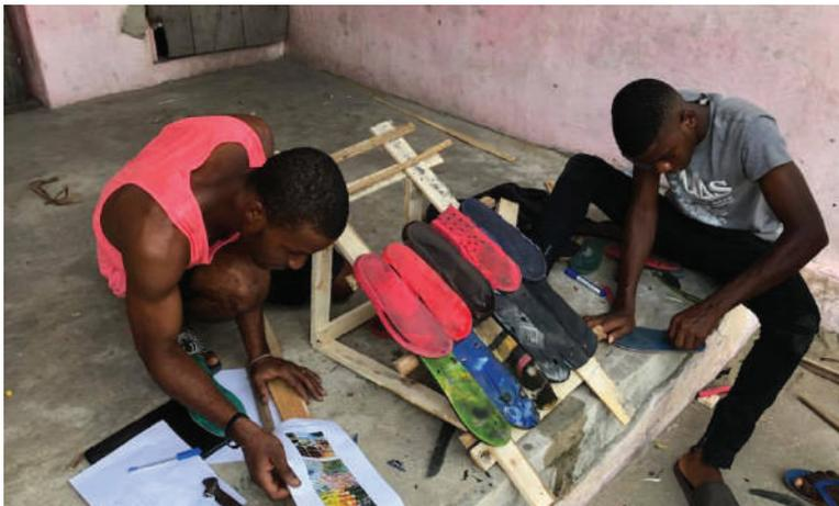
◀ Fabrication d'un prototype de toiture en semmeles de tongs
