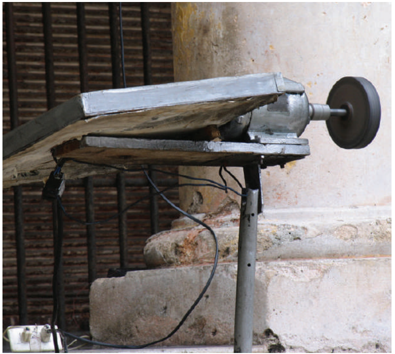
Polissoir de cordonnier utilisant un moteur de machine à laver Aurika ©Rikimbili
