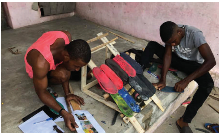
◀ Fabrication d'un prototype de toiture en semmeles de tongs ©L'Atelier des Griots
