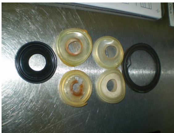
Figure 18: Mauvaise matière de joints utilisée
