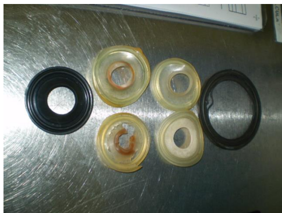
Figure 18: Mauvaise matière de joints utilisée
