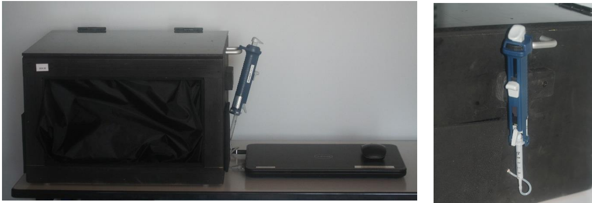
Figure 1 - Le système d'imagerie Calcivis relié à la boîte noire (ordinateur portable, souris et boîte noire)
