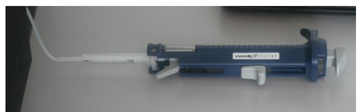
Figure 5 : pipette remplie de 0,5ml de la solution Calcivis® insérée dans le pipeteur dont l'extrémité est fixée dans le tube en silicone (relié à la boîte noire)
