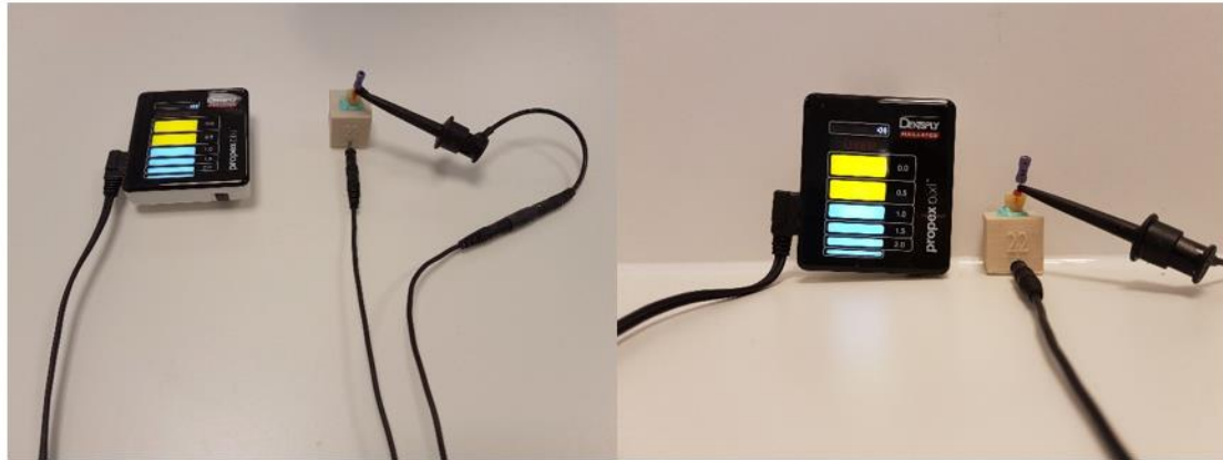
Figure 10 : photos d'un Propex Pixi® (Dentsply Sirona, Suisse) connecté au simulateur contenant une dent de l'échantillon
