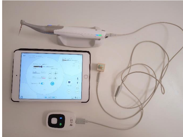
Figure 15 : IPAD ® (Apple, USA), du Propex IQ ® (Dentsply Sirona, Suisse), du X-Smart IQ ® (Dentsply Sirona, Suisse) et simulateur connectés entre eux
