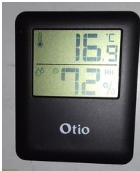
Illustration 5: Détail d'un des appareils d'enregistrement de données présents dans les réserves
