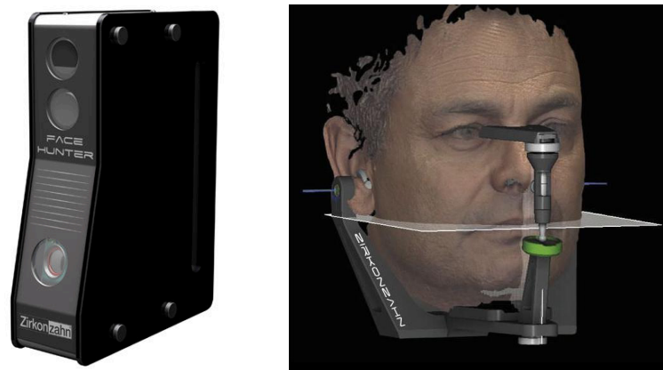
Figure 39 : Scanner 3D-Face Hunter de la société Zirkonzahn
