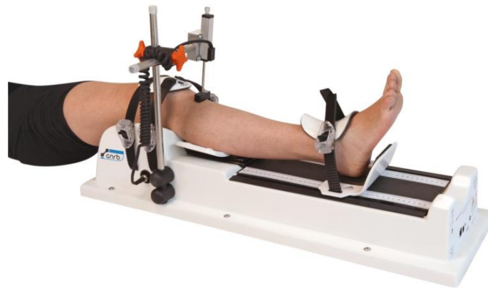
Figure 1: (A) Appareil de mesure de laximétrie instrumentale GNRB®, (B) Modélisation graphique comparative de la laxité pré et postopératoire d'une rupture du LCA genou droit
