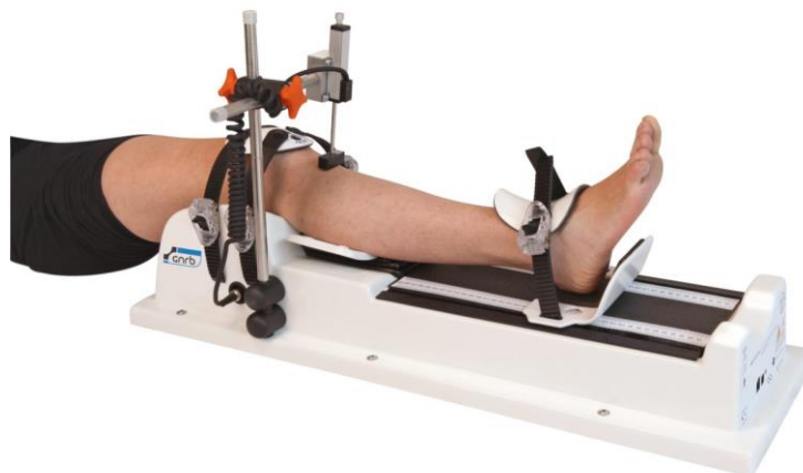
Figure 33. L'appareil de mesure de laximétrie instrumentale GNRB®
