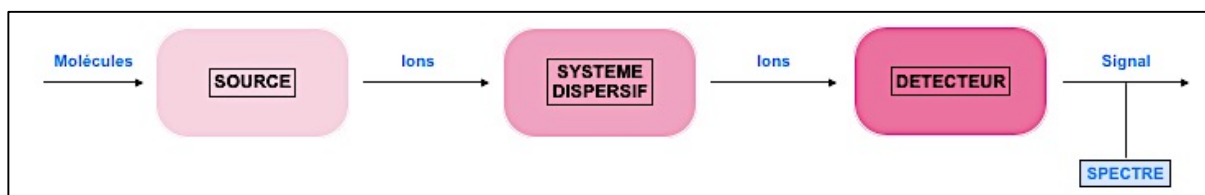
Figure 20 : Représentation schématique du spectromètre de masse.
