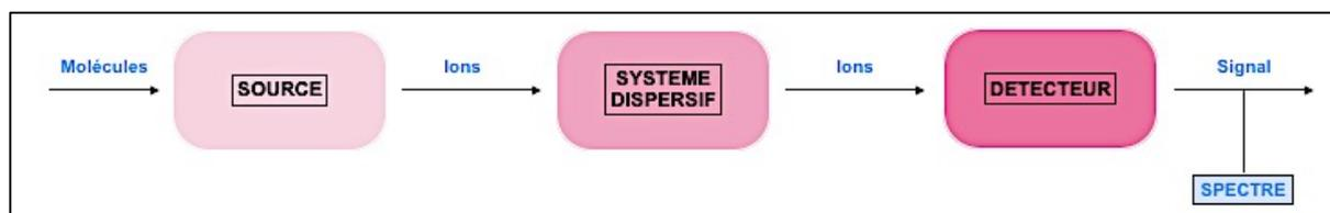
**Figure 20 : Représentation schématique du spectromètre de masse.**
