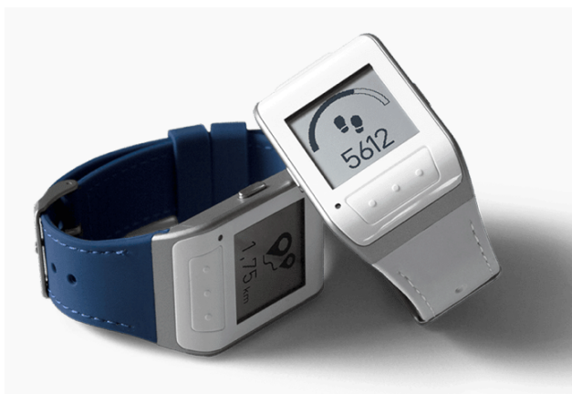
Figure 16: IKARYA watch intégrée d'un accéléromètre, développée par la société Telecom Design, faisant l'objet de notre étude. Source: www.vitalbase.com
