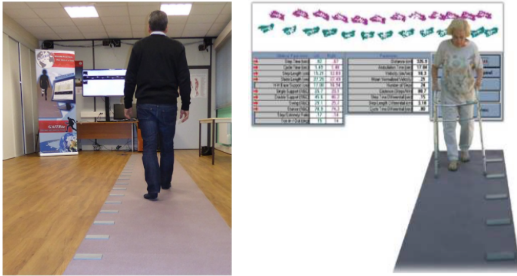
Figure 15: Exemple de tapis électronique type GAITRite, illustrations empruntées à A. Hamaoui
