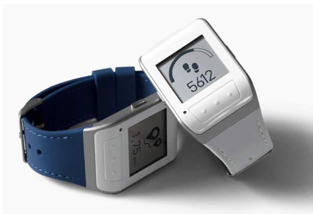
Figure 16: IKARYA watch intégrée d'un accéléromètre, développée par la société Telecom Design, faisant l'objet de notre étude. Source: www.vitalbase.com
