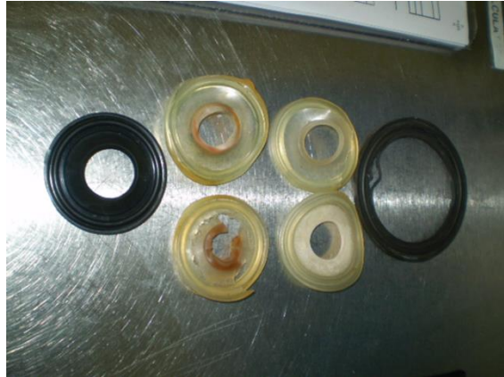
Figure 18: Mauvaise matière de joints utilisée
