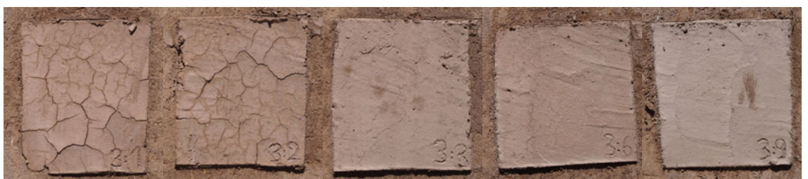
Tests de proportions entre la terre et le sable
