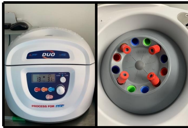
Figure 30 : Positionnement symétrique des tubes dans la centrifugeuse (PROCESS®) (Dr J. SURMENIAN)
