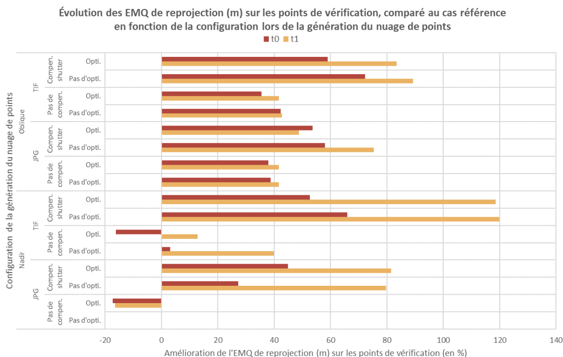
Figure 24 – Graphique comparant la précision atteinte en fonction des différentes configurations de génération des nuages de points. Auteur : Benoît Brizard
