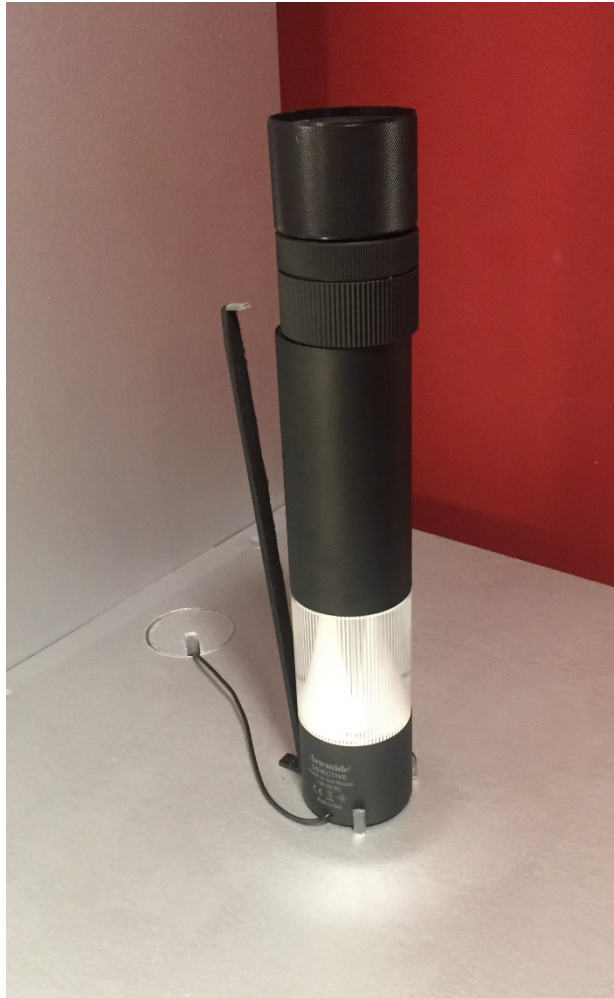
Figure 37. Soclage arraché de la lampe
