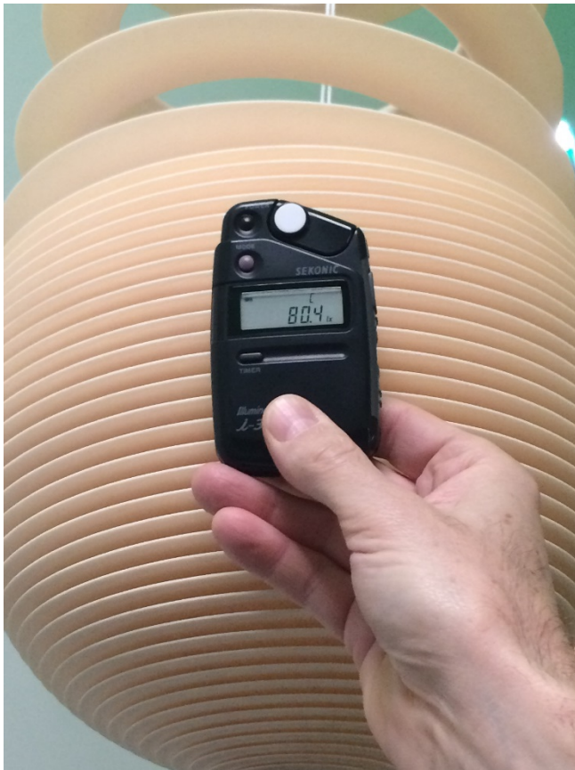
Figure 30. Mesure au Luxmètre de l'éclairage sur la suspension de Ron Arad
