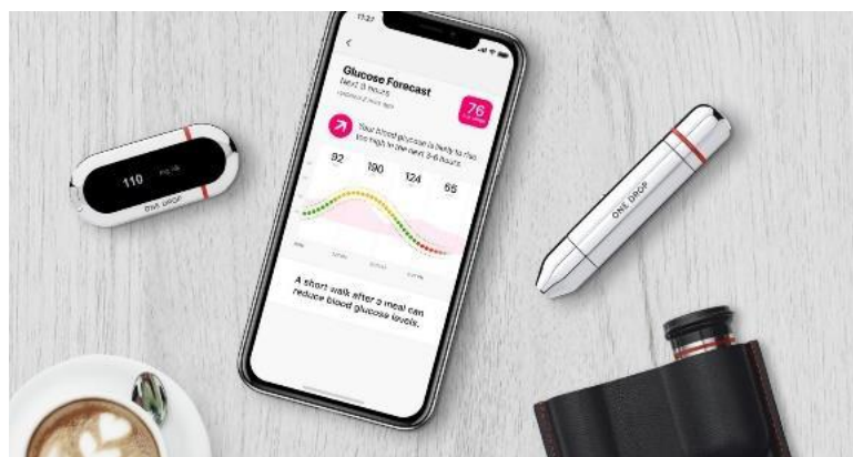
Figure 13 : Système sans fil de mesure de la glycémie
